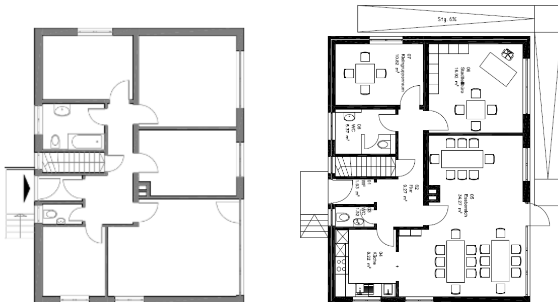
Bild 3: Hausmeistergebäude – Grundriss im Bestand Grundriss Umbau
